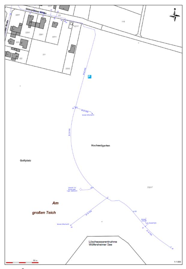
Abb. 19 Übersichtsplan der Wasserversorgung und der Löschwasserversorgung.
