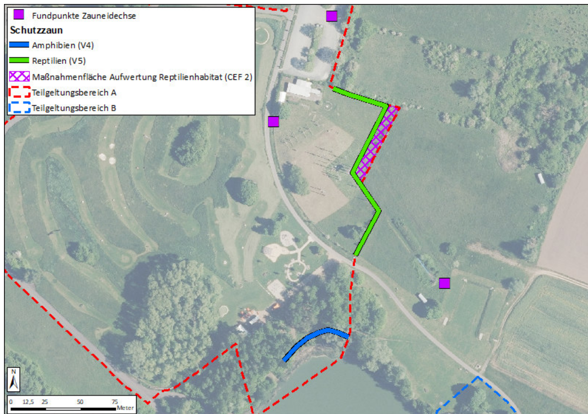
Abb. 5 Lage der zu errichtenden Schutzzäune für Amphibien (V4) und Zauneidechse (V5).
